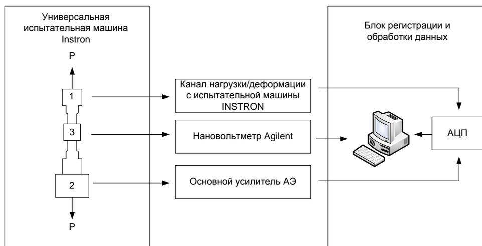
Рисунок 1 – Блок – схема установки для исследования механических параметров, АЭ и удельного электрического сопротивления; 1 – образец; 2 - пьезоэлектрический датчик АЭ; 3 – четырехзондовая головка
