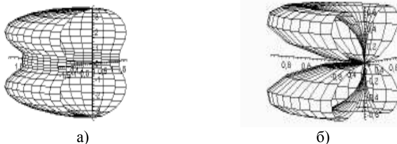
Рис. 3.1. а), б) Зависимость скоростей c_{\pm} от полярного угла при \lambda = 1
