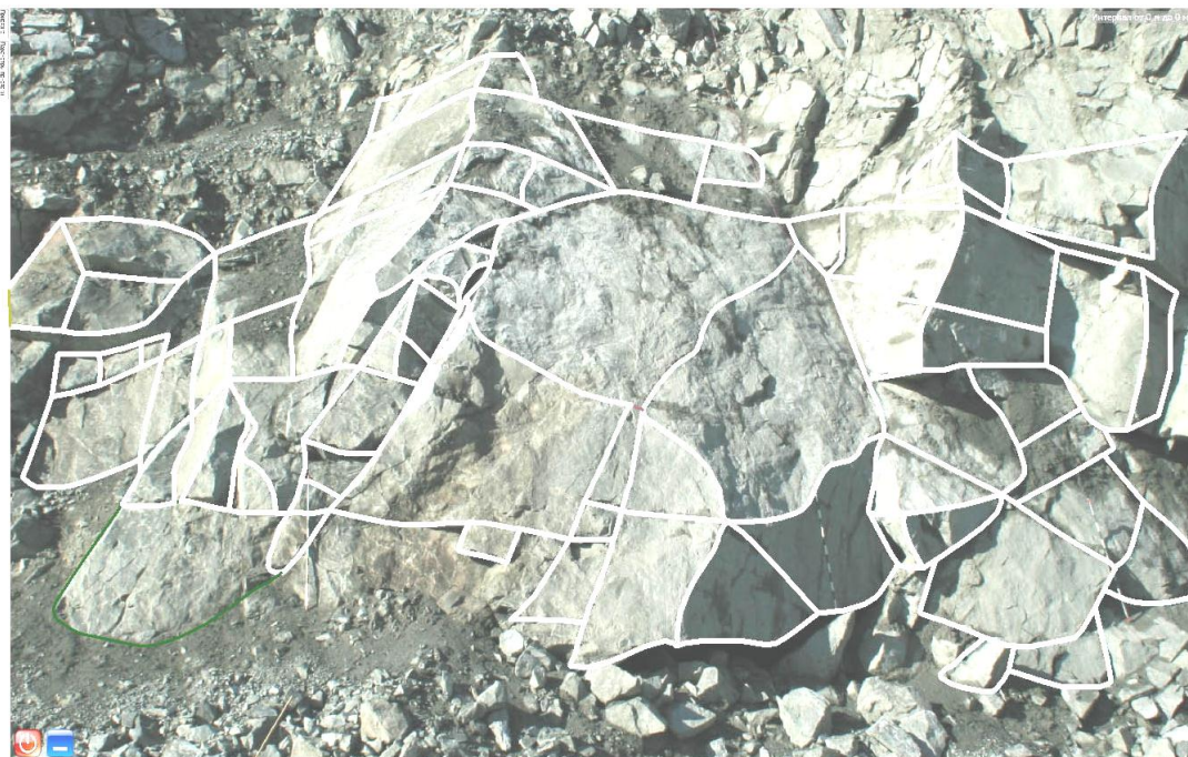
Рис. 3. Фотоснимок участка откоса уступа после векторизации Fig. 3. Photograph of a section of the slope of the ledge after vectorization
