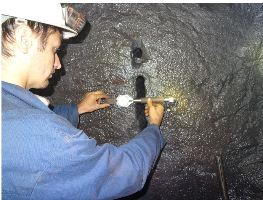
Рис. 3. Измерение горизонтальных деформаций механическим тензотроном после разгрузки массива
