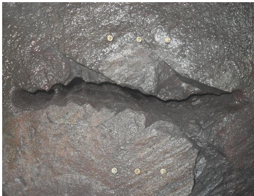
Рис. 4. Общий вид горизонтальной щели для определения вертикальной деформации разгрузки
