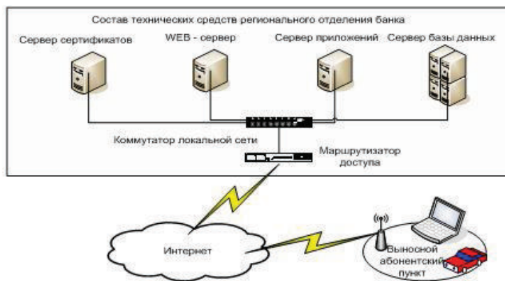
Рис. 2. Схема взаимодействия передвижного (выносного) абонентского пункта с региональными банковскими структурами
