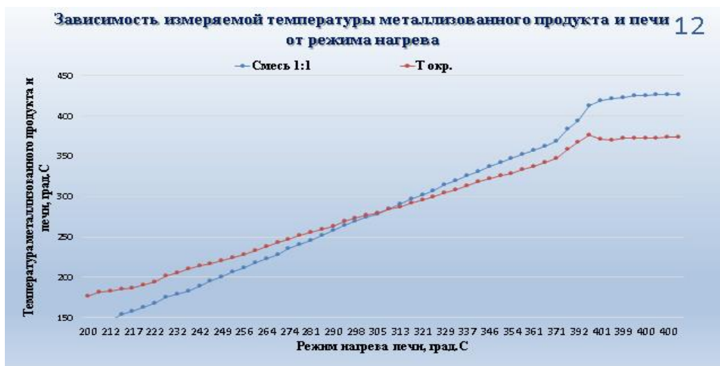
Рисунок 3. Исследование температуры самовозгорания металлизированного сырья
