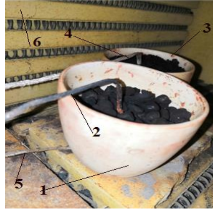
Рисунок 1. ГБЖ и металлизированное сырье в печи: 1 – емкость с металлизированным сырьем фрагменты брикетов более 6,5 мм, 2 – термопара для определения температуры внутри фрагментов, 3 – вторая емкость с металлизированной мелочью с фракциями менее 5 мм, 4 – термопара во второй емкости, 5 – термопара для определения температуры окружающей емкости среды, 6 – термопра для внутренней стенки печи СНОЛ
