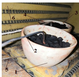
Рисунок 1 - ГБЖ и металлизированное сырье в печи
