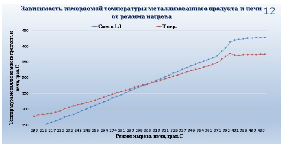
Рисунок 3. Исследование температуры самовозгорания металлизированного сырья.
