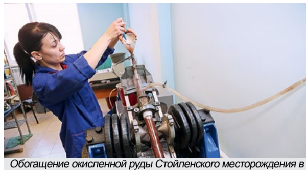
Обогащение окисленной руды Стойленского месторождения в слабом магнитном поле проводит младший научный сотрудник НИЛ ОМС Е.В. Гришкина
